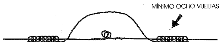
Figura 7.4 - Enmienda de alambres electrificados
