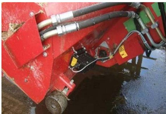
Figura 2. Analisador NIRS acoplado a equipamentos de manejo de alimentos.
